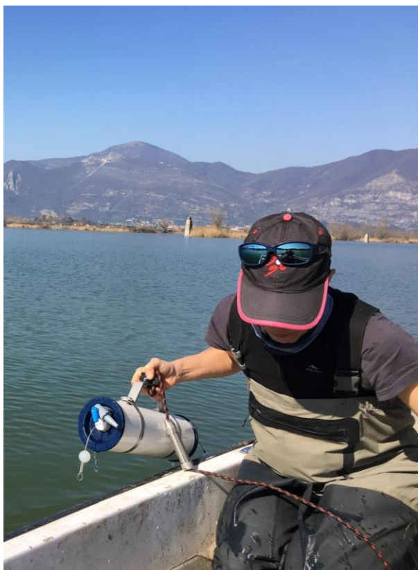
Figura 14 - Prelievo del campione d'acqua con bottiglia Van Dorn e misurazione dei parametri chimico-fisici
