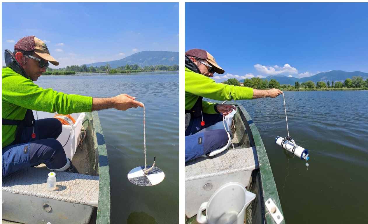
Figura 21 - misura della trasparenza con disco di Secchi e campionamento di fitoplancton
