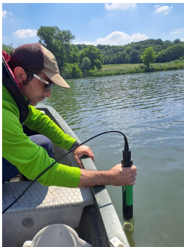
Figura 14 - Prelievo del campione d'acqua con bottiglia Van Dorn e misurazione dei parametri chimico-fisici
